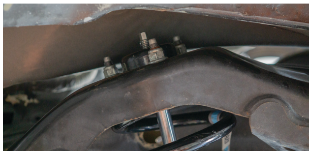
Fig. 28: Attach the top hat nuts.
