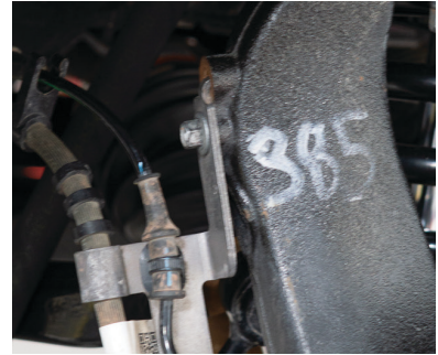
Fig. 23: Brake bracket bolt.
