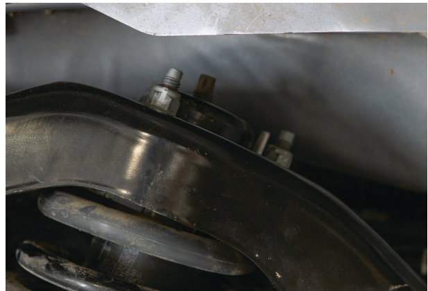
Fig. 26: Do not remove the center nut.
