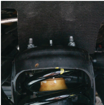
Fig. 17: Mount the top hat nuts.
