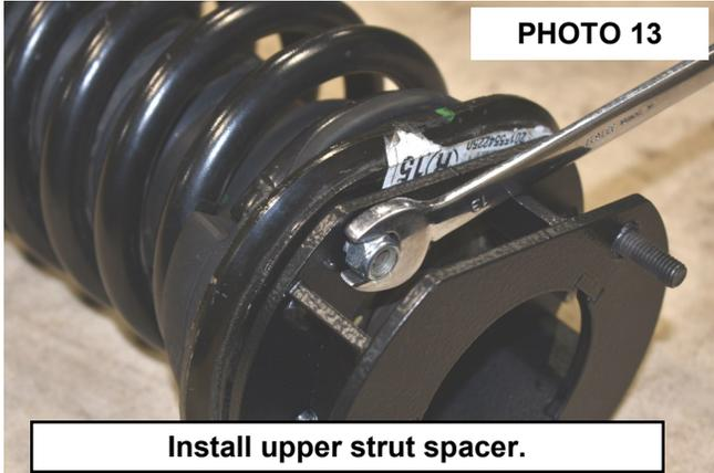
**Install upper strut spacer.**
