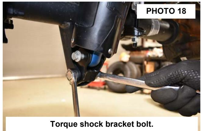
**Torque shock bracket bolt.**
