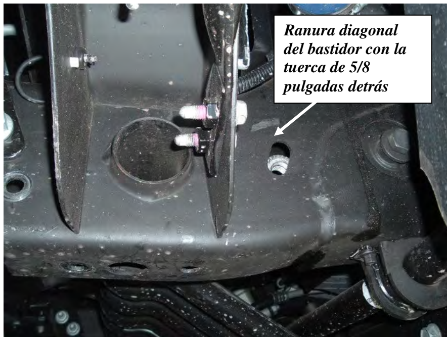
Figura 4 Ranura diagonal en el bastidor con la tuerca de 5/8 pulgadas en el lado izquierdo
