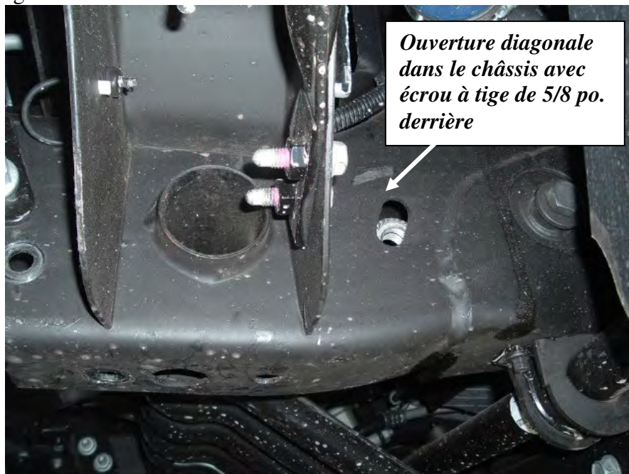
Figure 4 Ouverture diagonale dans le châssis avec écrou à tige de 5/8 po., châssis côté G présenté
